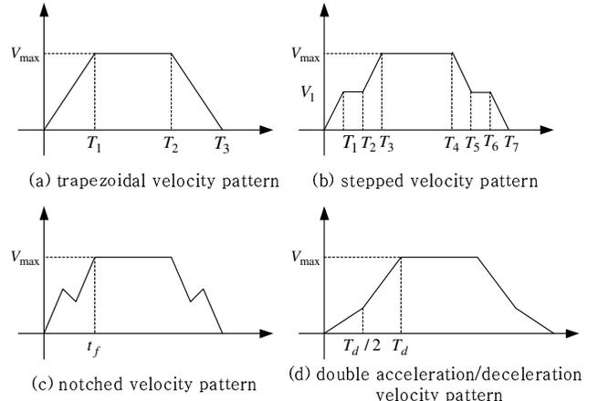
Fig. 11. Patterns of crane velocity (case (d) allows change in rope length)
